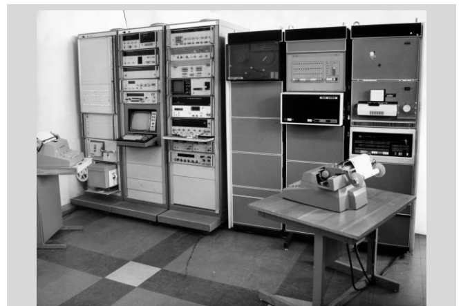
Система измерения и контроля полупроводниковых приборов и микросхем СВЧ диапазона в нелинейных режимах во временной и частотных областях
