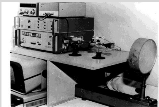
Лабораторный макет установки для измерения параметров антенных систем миллиметрового диапазона длин волн
